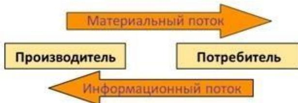
производителями и потребителями. Схема работы канбан. Перемещение информационных носителей в системе канбан происходит по принципу «супермаркета», схема которого изображена на рисунке ниже.
